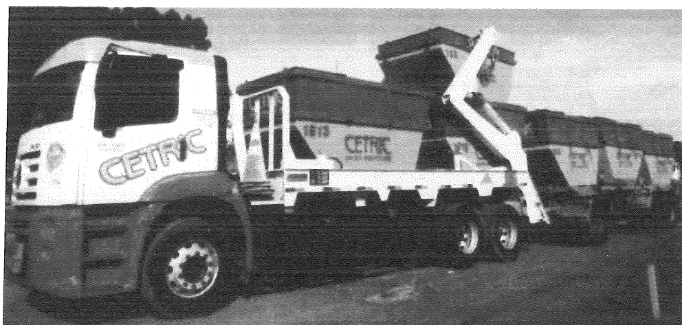
Figura 02 – Caminhão Poliguindaste (Contêineres de 4, 6 e 7 m³).
