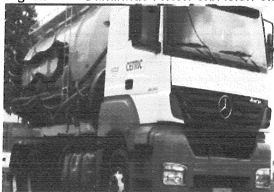
Figura 10 - Caminhão bomba a vácuo
